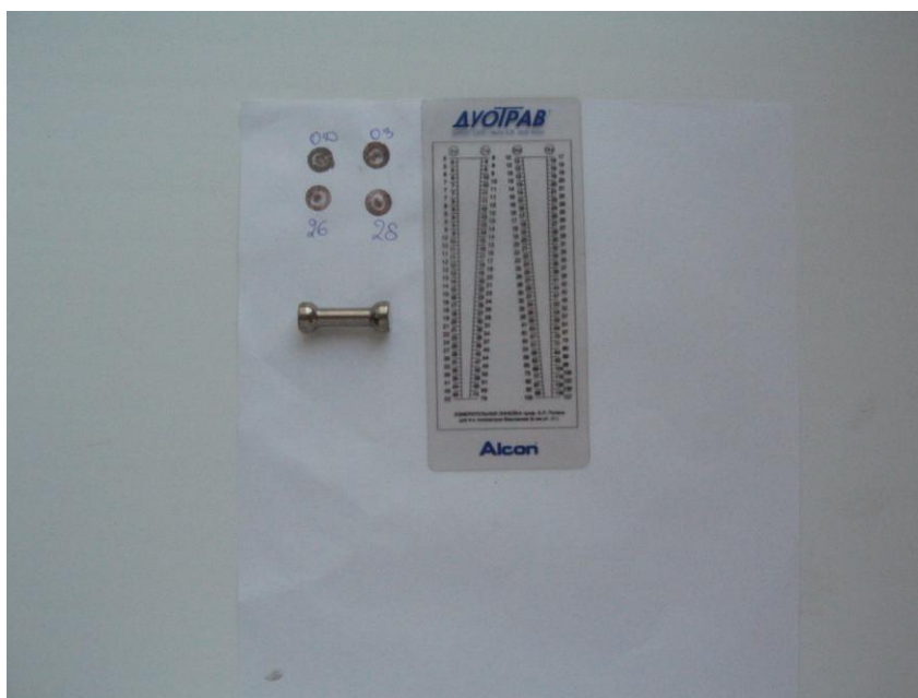
Рис. 14. 10-ти граммовый грузик и измерительная линейка Маклакова
